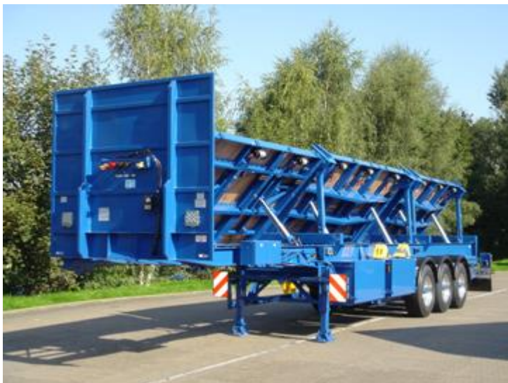
Schräglader Maximale Breite 4200 mm Verladung nur in horizontaler Position
