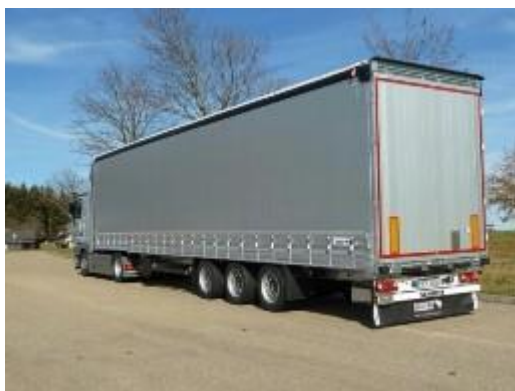
Tautliner maximale Breite 2400 mm
