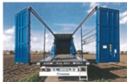
Tautliner, verbreiterbar maximale Breite 3000 mm
